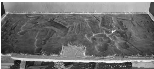
Lám. 8. Vaciado del relieve en resina de poliéster, sobre el molde de escayola realizado previamente.
